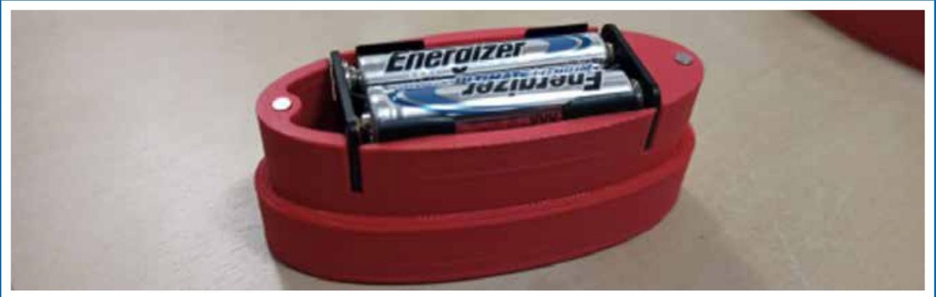
Die gezeigten Teile sind zur Befestigung des Haltebändchens gedacht (falls benötigt). Wenn ein Bändchen verbaut werden soll, befestige das Bändchen am unteren Teil mit einer Schraube, die 2mm dick und 8mm lang ist. Das solltest du tun, bevor du den oberen Teil mit den Magneten darauf klebst. Wir empfehlen die Magneten mit einem kleinen Tropfen Cyanacrylat-Kleber zu fixieren.
